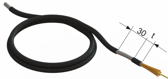
Figure 24 Dénuder le câble CEM sur 30 mm avant le branchement sur le bornier. La cote « t » correspond à la distance approximative du collier de fixation à la borne.
