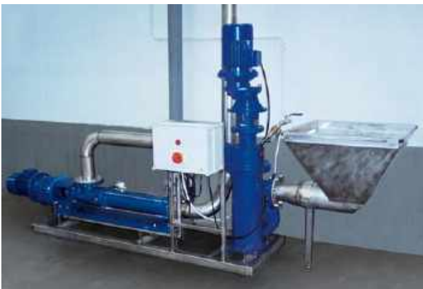
Pompe de la série BN 10-12 et dilacérateur 25U avec séparateur de solides Produit transporté : abats de volaille Débit : 4 m³/h • Pression : 6 bars • Température : 20 °C
