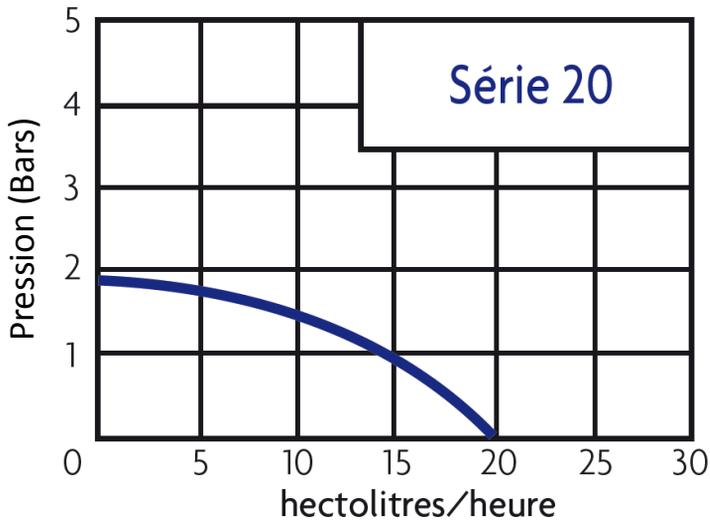
Essais effectués avec 10m de tuyau dans une eau à 10°C. Les pertes de charges peuvent être différentes selon la tuyauterie utilisée, la nature du produit véhiculé et l'impulseur.
