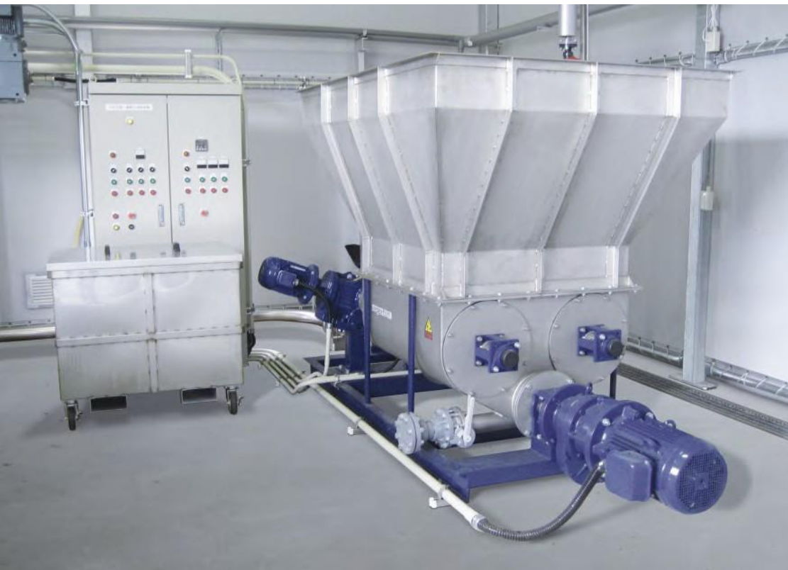
Pompe de la série BTEIM avec deux arbres à palettes, type de trémie spécial, section élargie et vis avec couteaux intégrés dans la zone de compression pour le transfert de déchets alimentaires.
