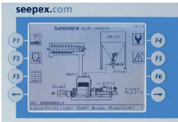
Affichage de la commande SLCO pour la surveillance du processus complet
