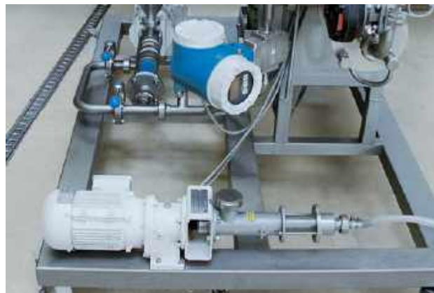
Pompe de la série MD 006-12 Produit transporté : pudding Débit : max. 120 l/h • Pression: 4 bars • Température : 20 °C
