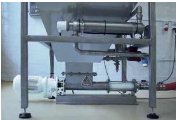
Pompe de la série BTCS 1-12 Produit transporté : mélange de fruits Débit : max. 380 l/h • Pression: 6 bars • Température : 5 à 40 °C
