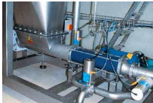
Pompe de la série BTCS 10-12 Produit transporté : pâte de tomates Débit : 1,3 m 3 /h • Pression : 4 bars • Température : 10 à 20 °C
