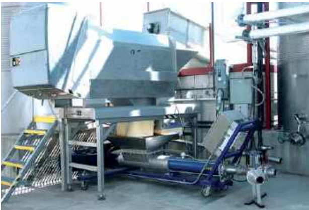
Pompe de la série BT 130-6L Produit transporté : moût Débit : 68 m 3 /h • Pression : 4 bars • Température : 20 °C
