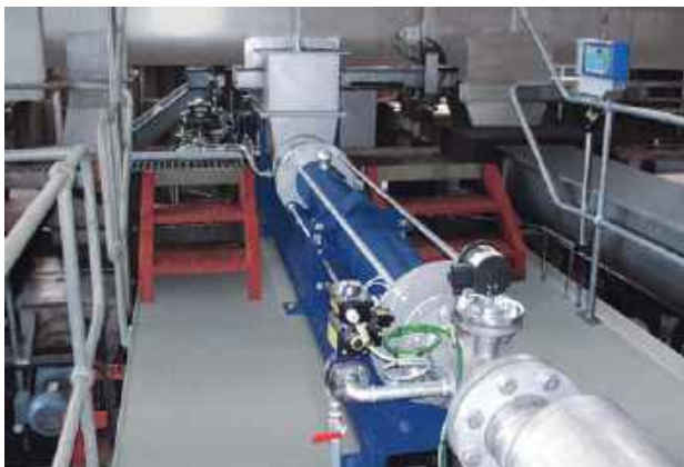
Pompe de la série TNS 130-12 Produit transporté : drêche de brasserie Débit : 40 à 50 m 3 /h • Pression : 6 bars • Température : 60 à 80 °C
