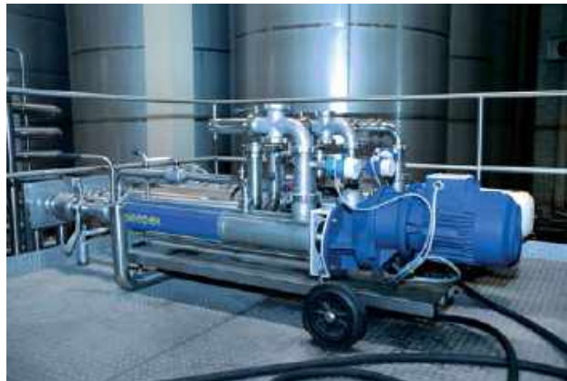
Pompe de la série BCSB 35-6L Produit transporté : vin Débit : 32 m 3 /h • Pression : 2 bars • Température : 20 °C
