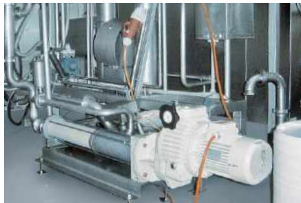
Pompe de la série BCSB 5-12 Produit transporté : levain Débit : 3 m 3 /h • Pression : 12 bars • Température : 20 °C
