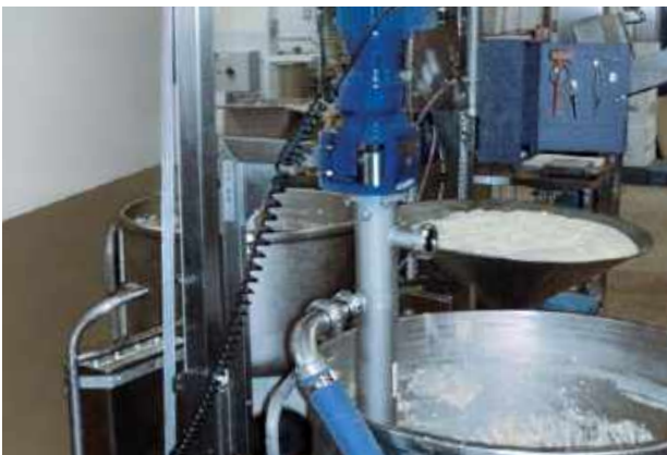
Pompe de la série BEK 1-12 (pompe immergée) Produit transporté : garniture à petits gâteaux Débit : 600 l/h • Pression : 2 bars • Température : 40 °C max.
