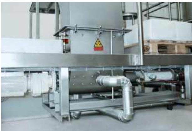
Pompe de la série BTCS 5-12 modèle chauffant Produit transporté : blocs de friture fondu pour gâteaux frits Débit : 400 kg/h • Pression : 8 bars • Température : 15 °C
