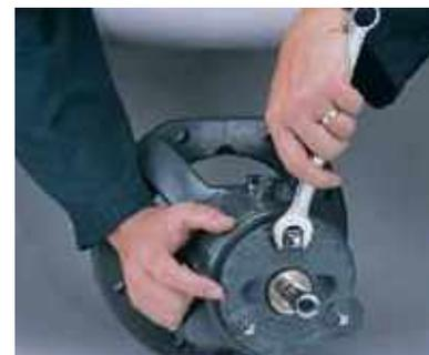
**Étape 3 :** Déplacez le porte palier dans le sens horaire selon le nombre d'encoches choisi. Serrez les vis d'arrêt et vérifiez le jeu de l'impulseur avec la jauge d'épaisseur.
