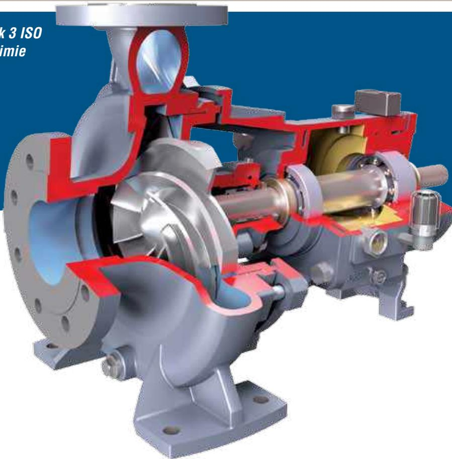
La pompe vortex Durco Mark 3 ISO permet un pompage avec destruction limitée des solides, même friables, et le pompage sans problèmes de boues fibreuses. Elle combine le système hydraulique hautement perfectionné de la pompe Mark 3 ISO standard avec l'effet vortex de l'impulseur reculé.
