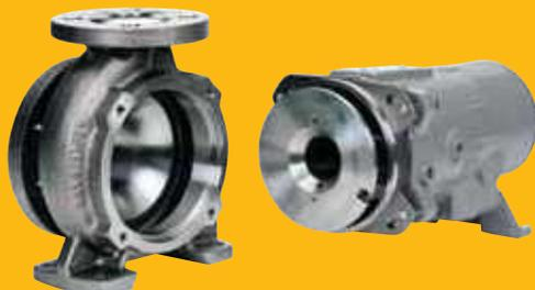
**Le démontage par l'arrière**, en version standard, facilite la maintenance générale et l'inspection. Le corps de la pompe demeure aligné et les connexions de tuyauterie ne sont pas démontées.
