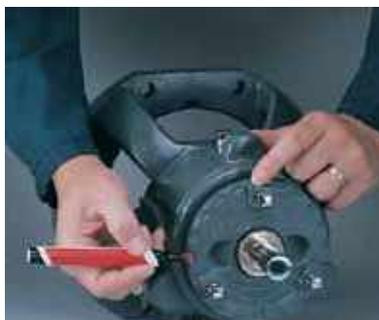
**Étape 2 :** Choisissez le jeu d'impulseur approprié. Chaque encoche de la bague du porte-palier correspond à exactement à un jeu de 0,10 mm. Si le jeu de l'impulseur doit être de 0,5 mm (0,020 po), comptez 5 encoches dans le sens anti horaire.
