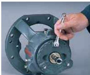
**Étape 1 :** Desserrez les vis d'arrêt. Avec une clé, tournez le porte-palier dans le sens anti horaire jusqu'à ce que l'impulseur touche légèrement la plaque de recouvrement arrière.
