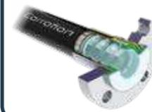
Le gainage PTFE des tubes Corroflon présente des convolutions très peu prononcées afin de minimiser la restriction des débits, tandis que le fil de renforcement externe dans les convolutions extérieures assure une pleine résistance à la dépression et à la flexion.
