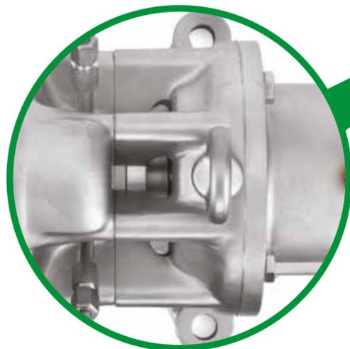
L'espace entre la zone humide (pompe à arbre nu) et la zone d'entraînement (boîte à roulement) de la pompe assure l'évacuation du fluide en cas de défaillance d'un joint, et élimine le risque de contamination.
