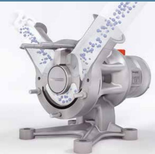
Un rotor sinusoïdal unique crée quatre chambres de taille égale. À chaque rotation d'une chambre, le fluide est acheminé du port d'aspiration au port de refoulement. Simultanément, la chambre opposée s'ouvre pour laisser pénétrer le produit, permettant un débit fluide quasiment sans pulsation.
