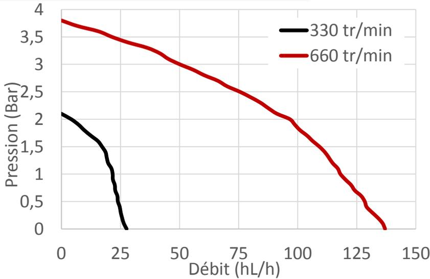
Essais effectu es avec 3m de tuyau dans une eau   15 C. Les pertes de charges peuvent  tre diff erentes selon la tuyauterie utilis ee, la nature du produit v hicul e et l'impulseur.
