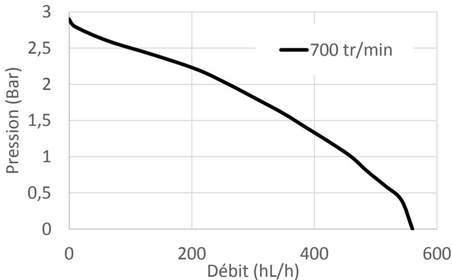
Essais effectués avec 10m de tuyau  $\varnothing 70$  dans une eau à 15°C. Les pertes de charges peuvent être différentes selon la tuyauterie utilisée, la nature du produit véhiculé et l'impulseur.
