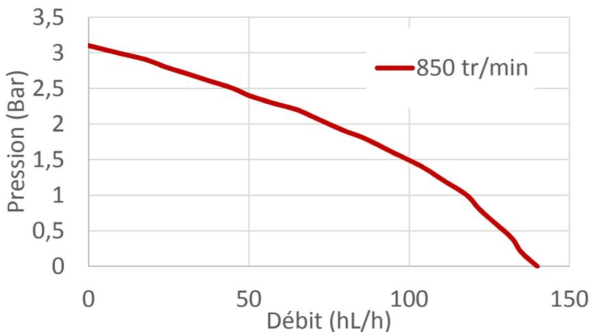
Essais effectués avec 3m de tuyau dans une eau à 15°C. Les pertes de charges peuvent être différentes selon la tuyauterie utilisée, la nature du produit véhiculé et l'impulseur.
