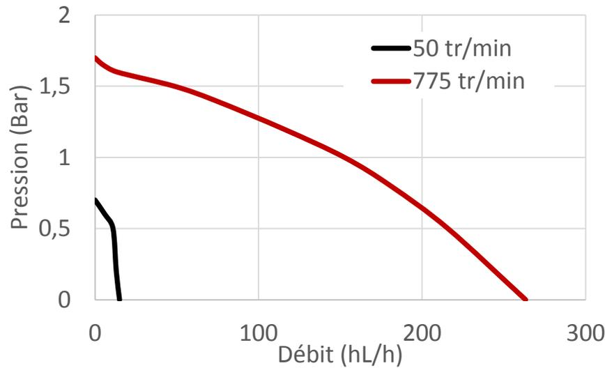
Essais effectu es avec 3m de tuyau  $\varnothing 50$  dans une eau   15 C. Les pertes de charges peuvent  tre diff erentes selon la tuyauterie utilis ee, la nature du produit v hicul e et l'impulseur.
