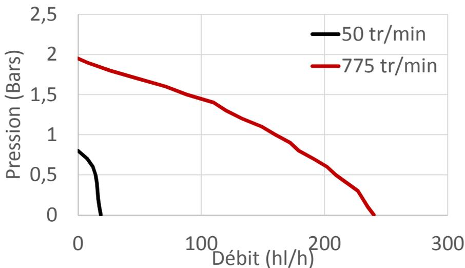
Essais effectu es avec 3m de tuyau dans une eau   10 C. Les pertes de charges peuvent  tre diff erentes selon la tuyauterie utilis ee, la nature du produit v hicul e et l'impulseur.
