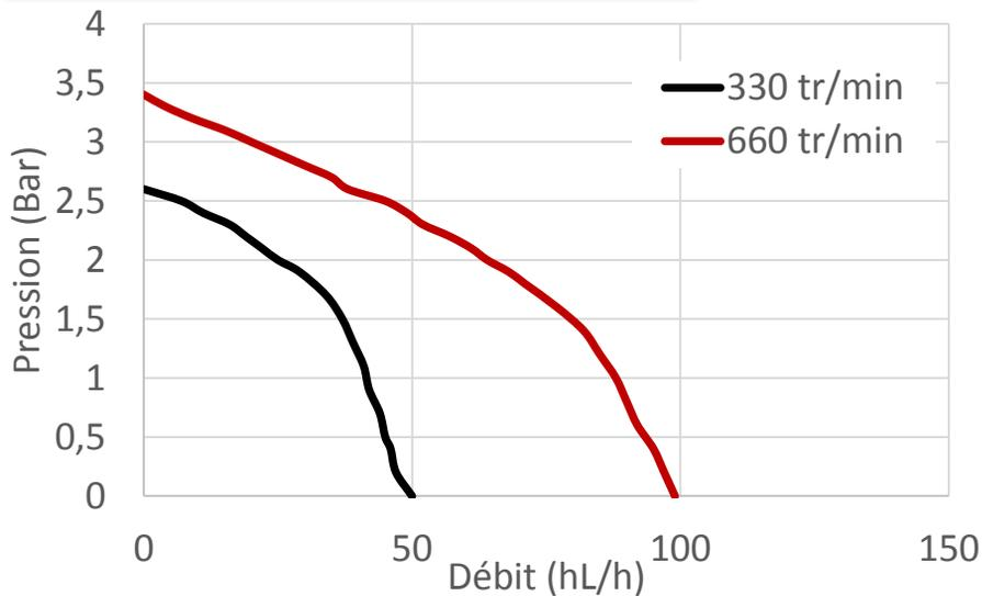
Essais effectués avec 3m de tuyau Ø50 dans une eau à 15°C. Les pertes de charges peuvent être différentes selon la tuyauterie utilisée, la nature du produit véhiculé et l'impulseur.
