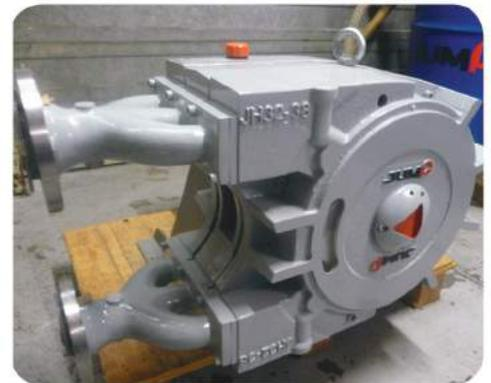
Pompe JH38 triple sur châssis fixe
