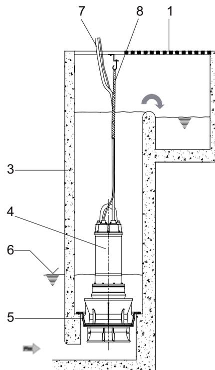
Figure 15b VUPX/AFLX avec puits montant en béton
