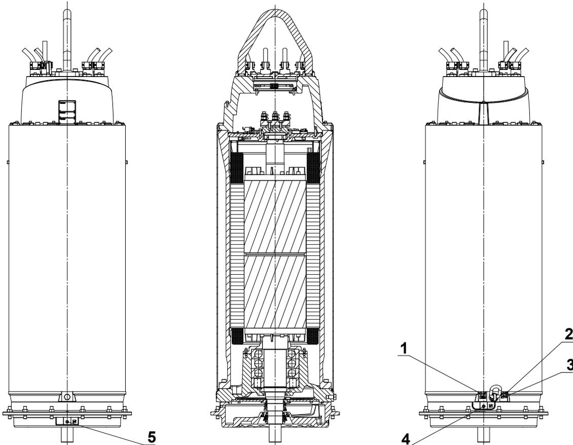
Figure 28 remplir et vidanger le lubrifiant XFP PE7
