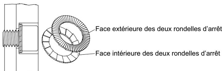
Figure 14 Position de montage des rondelles d'arrêt Nord-Lock®
