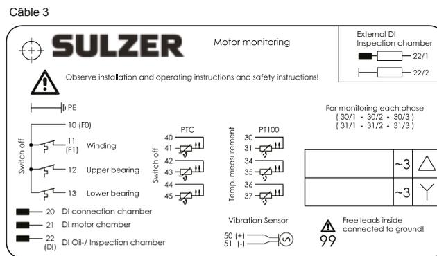
Figure 20 Versions spéciales : Deux câbles de raccordement moteur et un câble de commande - pour la surveillance optionnelle du moteur
