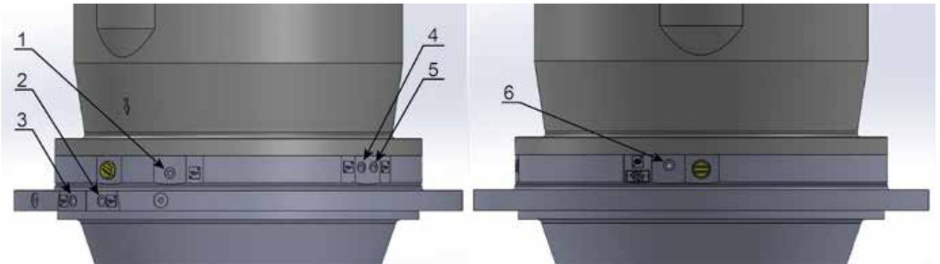
Figure 29 remplir et vidanger le lubrifiant VUPX / AFLX
