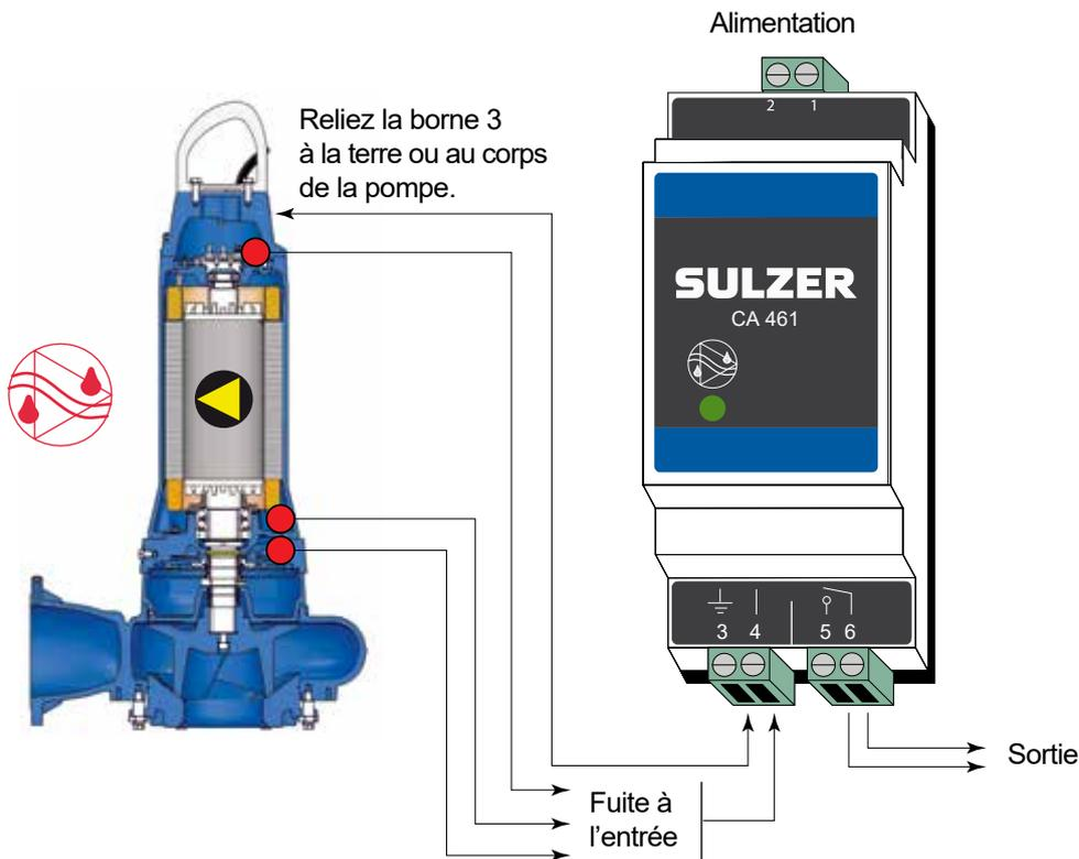
Figure 23 Contrôleur de détection de fuite CA 461 d'Sulzer
