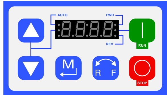
Figure 11 Panneau de commandes de VFD
